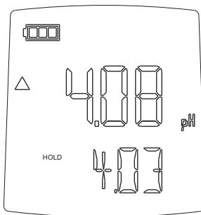
Unter dem aktuellen Messwert erscheint nun eine zweite Anzeigezeile. Darin befindet sich links der Schriftzug HOLD, rechts daneben der festgehaltene pH-Messwert.
