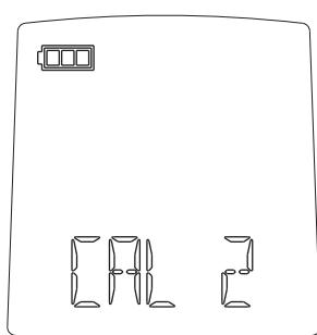
◆ Geben Sie als Nächstes an, ob Sie die Messkurve des Gerätes mit einer, mit zwei oder mit drei Pufferlösungen kalibrieren wollen. Drücken Sie dazu die Tasten ▼ oder ▲, bis »1PC«, »2PC« oder »3PC« angezeigt wird.
